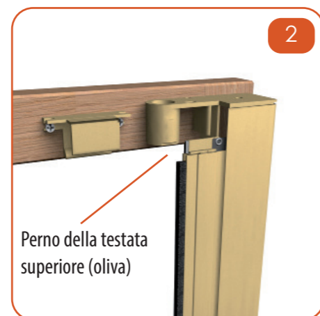
2 Posizionare il cassonetto in modo tale che la testata con il perno in vista (oliva) sia posizionata dal lato superiore.
