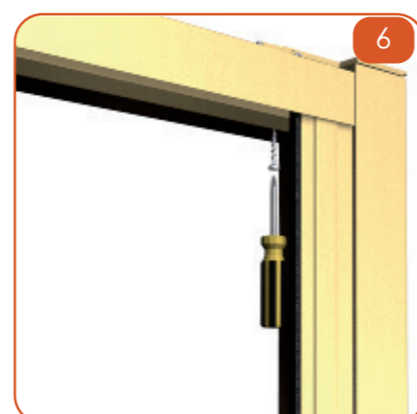
6 Fissare la guida superiore alla testata, inserendo la vite nel foro della guida.
